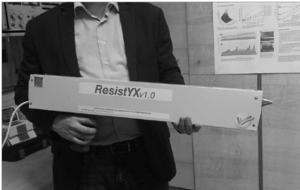
Рис. 2. Мобильное устройство для оперативной диагностики древесины и деревянных конструкций
